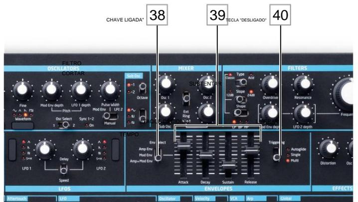
Bass Station II tem um controle deslizante dedicado para cada parâmetro ADSR. O conjunto de controles deslizantes ajustará o(s) envelope(s) selecionado(s) pela chave Env Select 38: o envelope de amplitude, o envelope de modulação ou ambos juntos.
